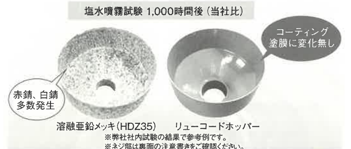
写真10 リューコートホッパー塩水噴霧試験結果
